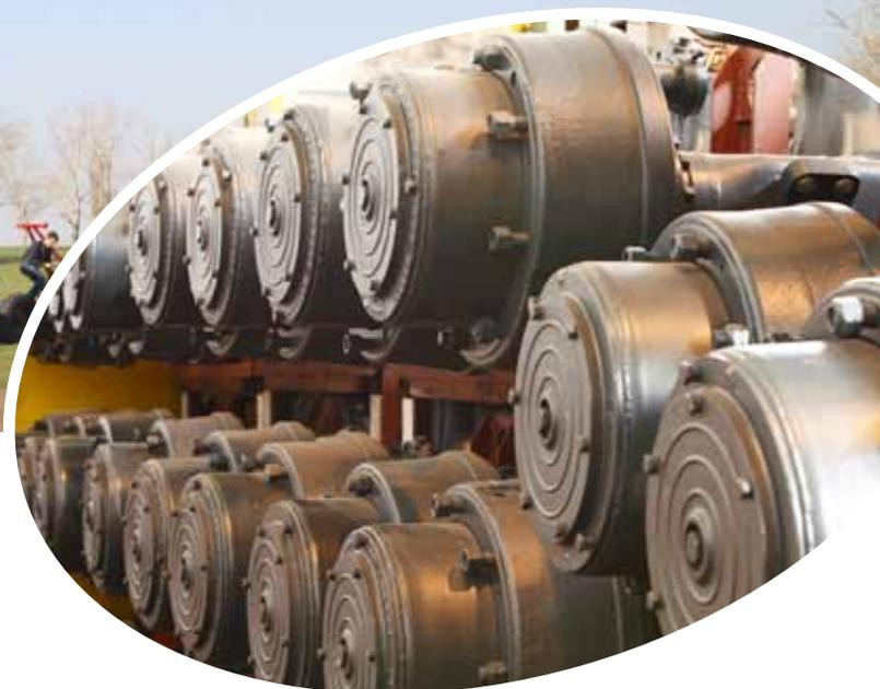
ЛКМЗ — эксклюзивный изготовитель штампованных корпусов мостов для тракторов и дорожно-строительной техники в Украине и один из двух подобных заводов во всем СНГ.
