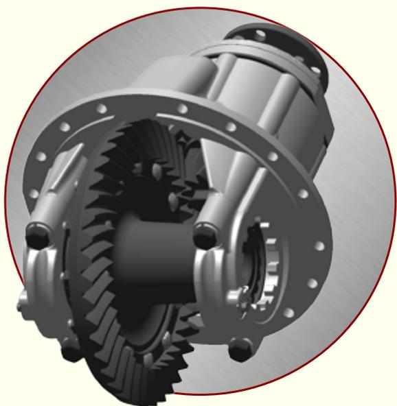
С 2011 г. на предприятии была кардинально изменена конструкция всего дифференциала, что позволило в три раза снизить удельные давления на дисках трения, исключив при этом основную причину образования на них задиров и, соответственно, ранней потери блокировки.
